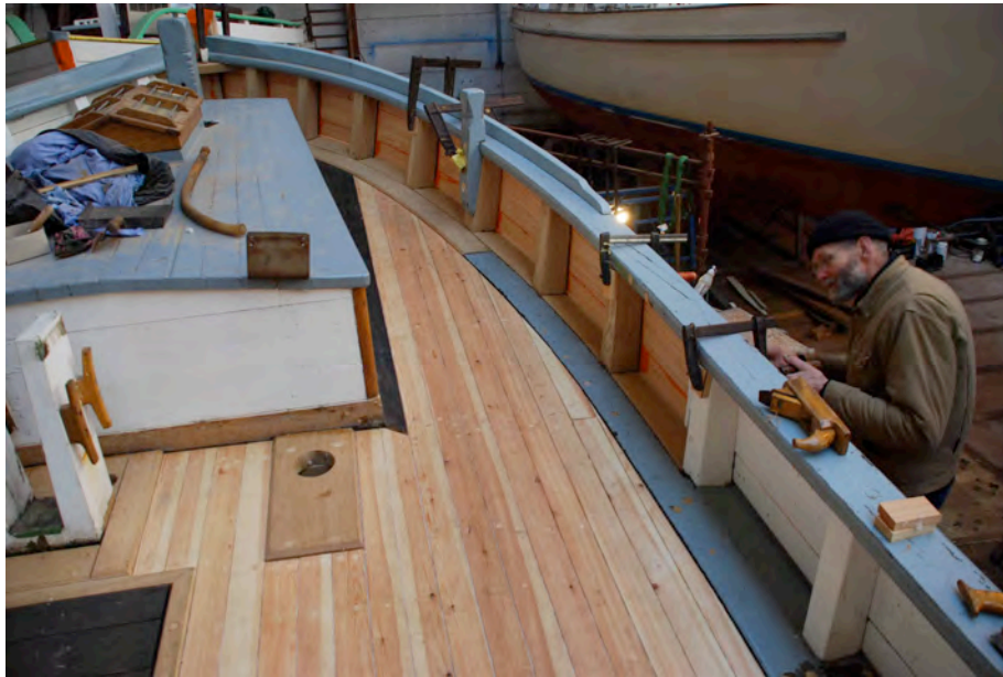
Marna ses her med færdigt dæk og nye støtter, skandæk og skanseklædning
