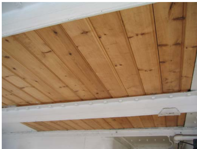
Dæksplankerne er fastgjorte til bjælkerne med galvaniserede dæksbolte. Her har værftet anvendt firkantmøtrikker, som originalt. Foto: SBF/Tom Rasmussen
