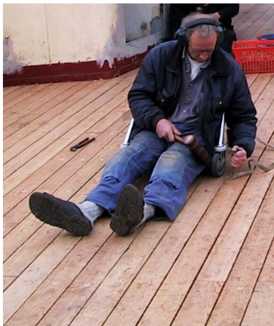
Skibstømmer Morten Müller kalfatrer det nylagte dæk på bilfergen MØN. Han sidder godt i en speciallavet stol/skammel med rygstød og hjul. Dæksplankerne er af sibirisk lærk, da velegnet fyrretræ ikke lod sig fremskaffe på tidspunktet. Foto: SBF Jes Kroman
