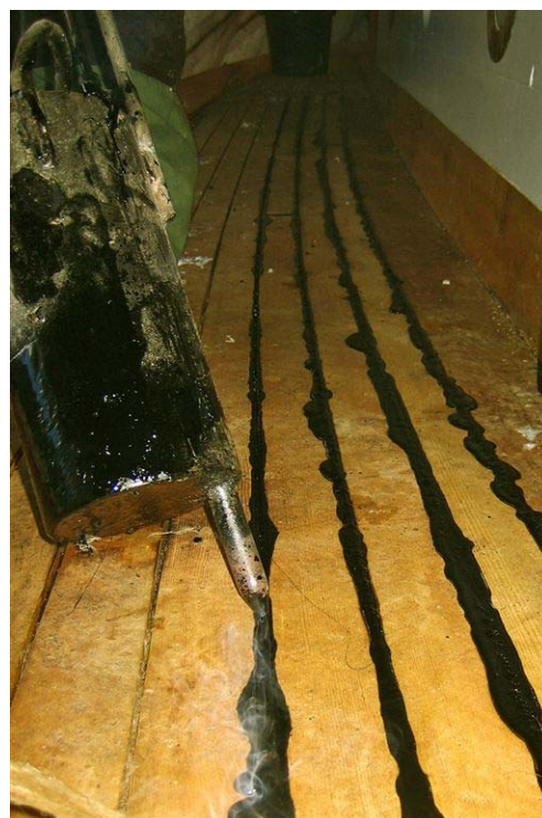
Færgebåden ESPINA EHLERS får lagt nyt dæk på Lillebæltværftet vinteren 2009-10. Skibstømmer Mads Miller anvender en begøse med lukkeventil i bunden, styret af et greb oppe ved håndtaget, og som slipper beget ud i en kontrollerbar mængde. Foto: SBF Jes Kroman
