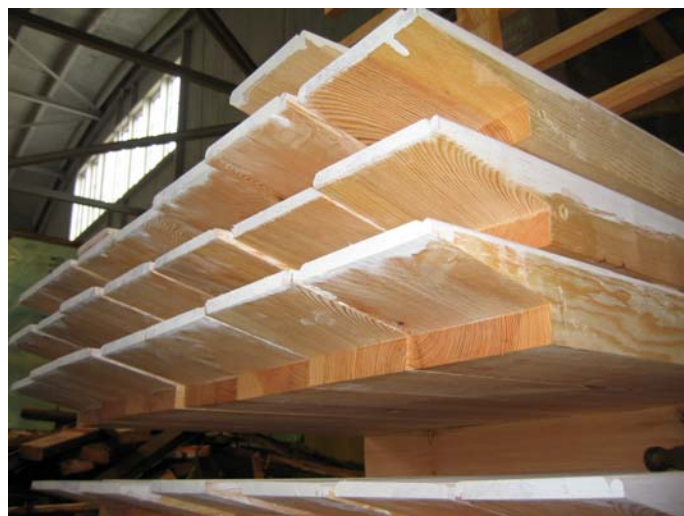
Dæksplanker af fyrretræ i prima kvalitet. Plankerne har meget tæt vækst. På enderne er hovlet en skralask, hvilket fortæller os, at plankerne skal lægges på vinkeljerns dæksbjælker. Foto: SBF/ Tom Rasmussen
