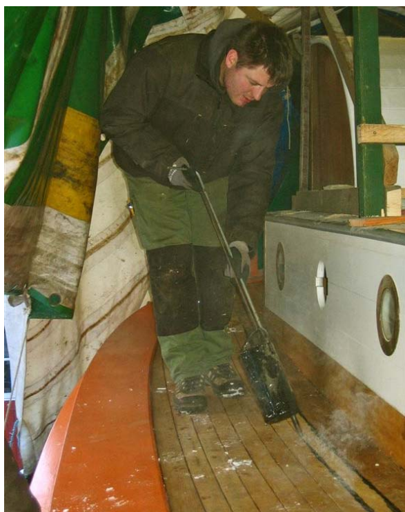
Færgebåden ESPINA EHLERS får lagt nyt dæk på Lillebæltværftet vinteren 2009-10. Skibstømmer Mads Miller anvender en begøse med lukkeventil i bunden, styret af et greb oppe ved håndtaget, og som slipper beget ud i en kontrollerbar mængde. Foto: SBF Jes Kroman
