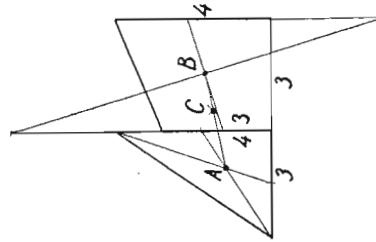
Den næste figur viser et andet eksempel. Man vil finde det samlede tyngdepunkts beliggenhed i forhold til de to linier nærmest X- og Y-(X-aksen og Y-aksen) og vil udelukkende bruge beregning. De to øgige tyngdepunktsafstande kaldes x og y.
