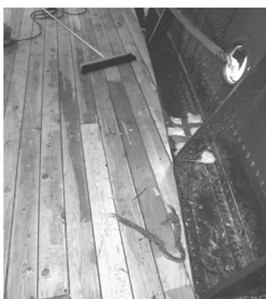
Figur 1: Randplanke med hage. Figur 2: Dæksplanken opfanger sin makkers spidser. I begge tilfælde vil enderne på dæksplankerne mod midten løbe ud mod rendestensvinkelen agterude, Under: Dæk kan også være lagt uden randplanke. Da løber spidserne ud mod rendestensvinkelen, som her på M/S Hindholmen
