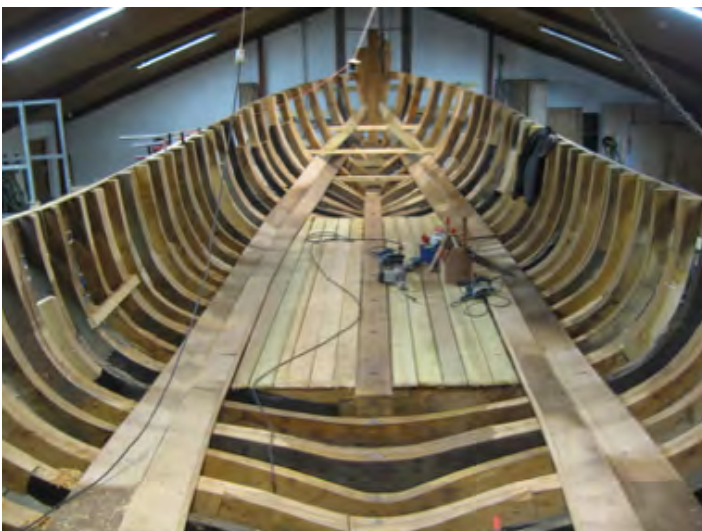
GØL i de nye værkstedsfaciliteter, klar til garnering og dæksbjælker.
