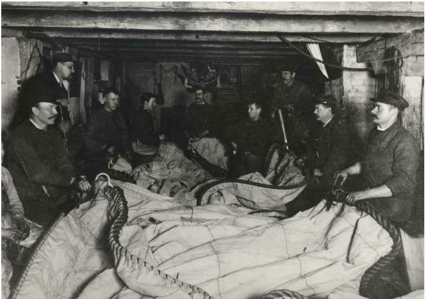
Det traditionelle sejlmageri er et håndværk, som ovenstående foto fra N. J. Petersens sejlmagerloft, Helsingør ca. 1890, illustrerer. I dag kan vi risikere at nye gaffelsejl af kunstfiber er skåret ved hjælp af en computer. Mange sejlmagere faconskærer ligene for at skabe sejlets posning, men undlader at udnytte ligtovets funktion. Ligtovet skal både styrke sejlet og forme dets posning, men sys ofte lige derudaf og fungerer kun som romantisk staffage. Foto i Handels- og Søfartsmuseet på Kronborg.
