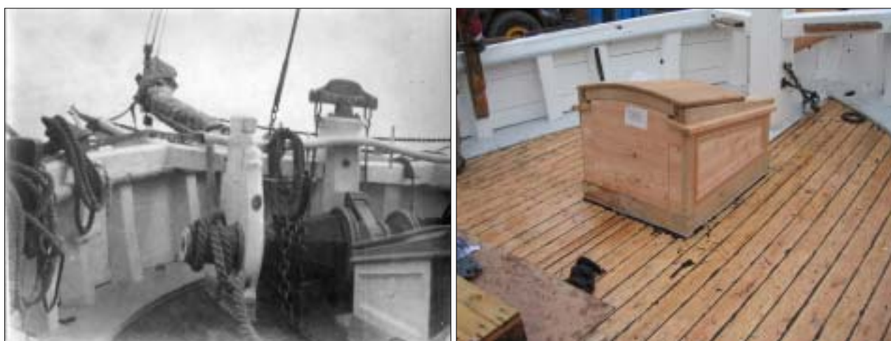
Billedet til venstre viser fordækket på galeasen Skibladner II , bygget i Odense i 1897. Fotoet dokumenterer hvordan nedgangskappen fremstod ca. 1900 og var hovedkilden for en rekonstruktion i 2005. Til højre den færdige kappe.
